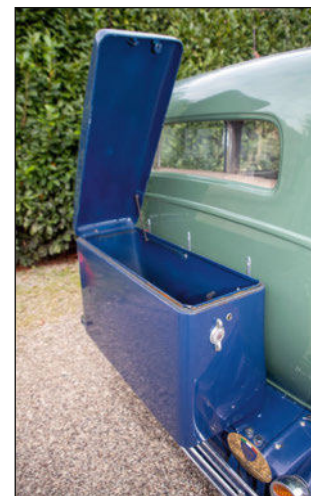
Le coffre à bagages fait honneur à son nom : c'est un coffret monté à l'extérieur. Son articulation sur la gauche facilite le déchargement des bagages côté trottoir.
