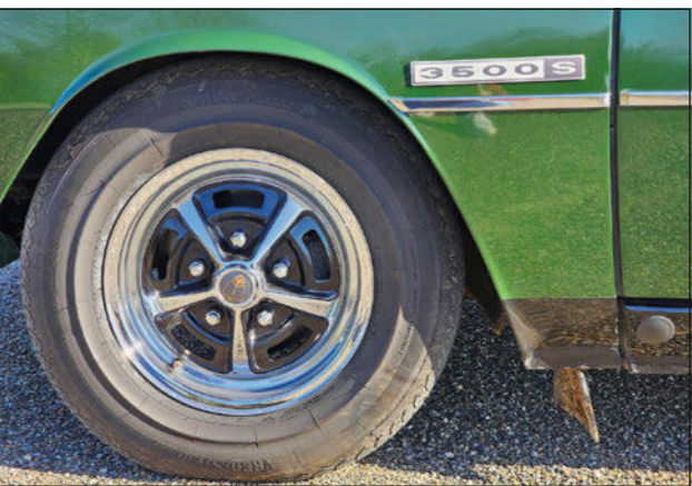
Ces magnifiques roues Rostyle étaient disponibles en supplément. Les bas de caisse noirs sont spécifiques aux P6 produites à partir de 1971. Le bouchon en caoutchouc permet d'obstruer l'un des quatre passages de cric.
