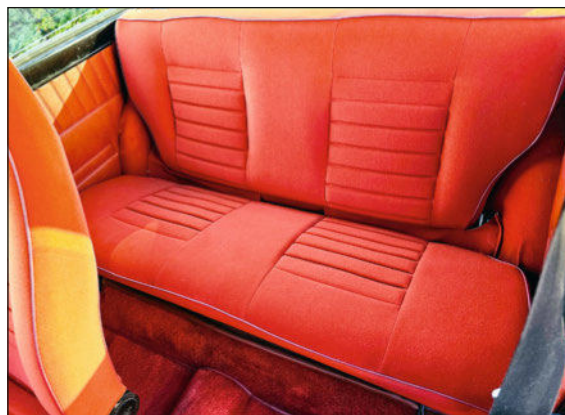
La banquette arrière se rabat de façon à augmenter le volume du coffre encombré par la roue de secours.
