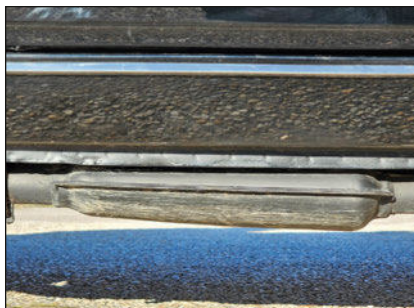
Spécifique à ce modèle, le système d'échappement est très particulier puisqu'il part de l'aile avant gauche pour aboutir derrière la roue postérieure droite.
