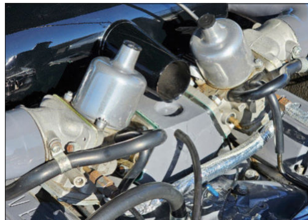
Chacun des carburateurs SU alimente deux cylindres d'un rang et deux de l'autre.
