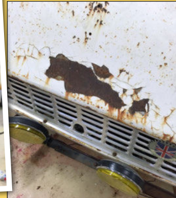
La grosse trace de rouille visible sur la face avant n'est pas perforante.
