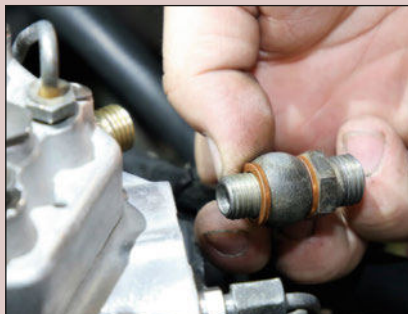
On repose le banjo et les joints neufs sur le raccord d'entrée du doseur.
