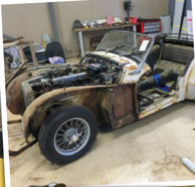
La dépose des éléments de carrosserie se poursuit avec les ailes et les portes.
