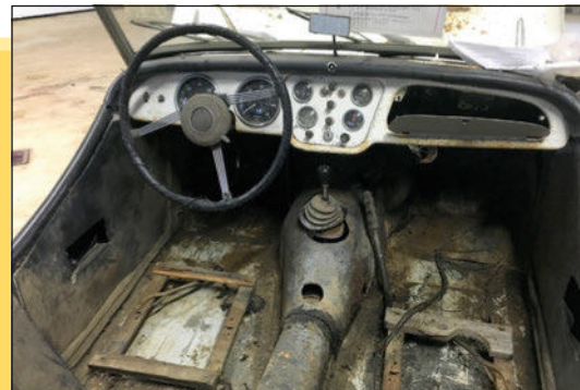
Les compteurs sont en piteux état, mais ils seront restaurés, sauf celui de la température moteur. Idem pour tous les interrupteurs. Les garnitures intérieures sont fichues et on peut voir que les rails de supports de sièges ont été bien bricolés avec des tasseaux en bois ! Les planchers ne semblent plus être ceux d'origine.
