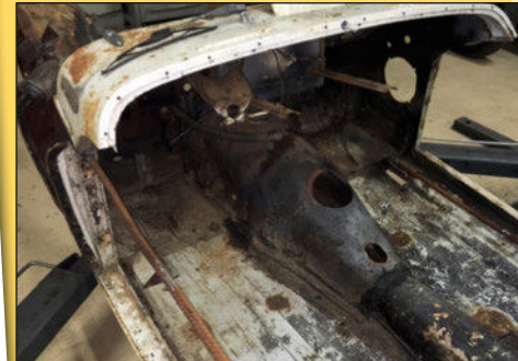
L'intérieur est complètement démonté. Les planchers ont été refaits avec des tôles de bardage pour bâtiment vissées à l'autoforeuse et étanchéifiées avec un enduit bitumineux bien connu. Un chalumeau et une spatule vont être nécessaires pour tout retirer.
