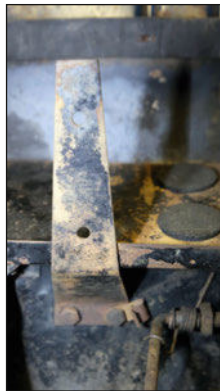
5 Le bac à batterie tient par une patte qui retient en même temps la batterie.
