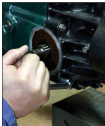
23 On les serre avec une clé de 12 mm.
