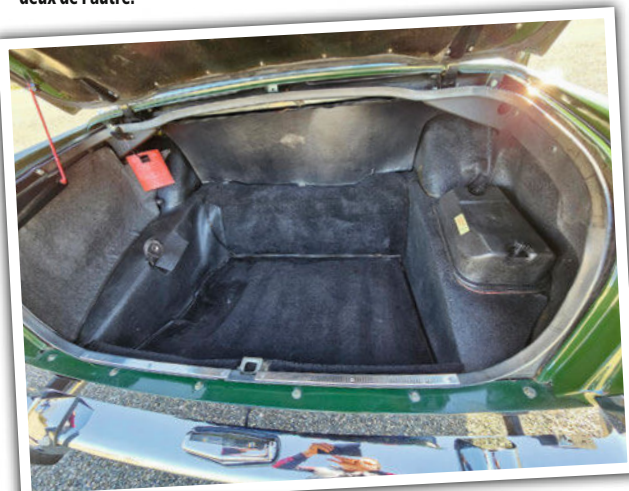
L'option roue de secours sur le couvercle de malle dégage agréablement le coffre à bagages. À droite est nichée la batterie dans son logement.
