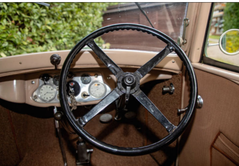
Au centre du volant se trouve le réglage de l'avance. Le dessin à quatre branches était encore à la mode au début des années 30. La 469 a pourtant été présentée en 1921 (et elle a peu changé depuis).
