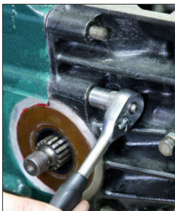
22 On peut ensuite approcher les écrous positionnés autour des sorties de pont.
