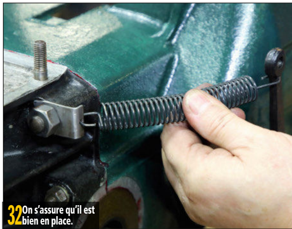
30 On remet ensuite le ressort de rappel sur la patte.
