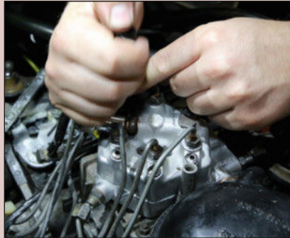
On serre le raccord.
