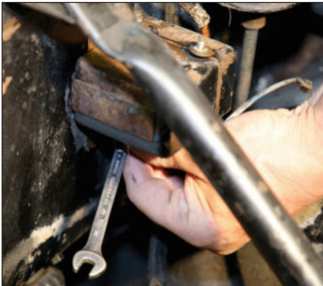
17 Au moyen d'une clé de 8 mm, on libère le fil blanc d'excitation du démarreur.
