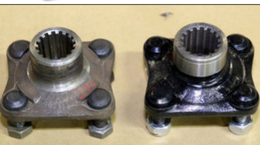
1 Les anciens plateaux de sortie sont remplacés par des modèles reconditionnés (à droite) dont la portée, rectifiée, a été résinée et rebagüée.
