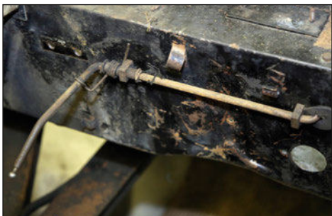
1 Sur la traverse inférieure, il reste la commande d'accélérateur.
