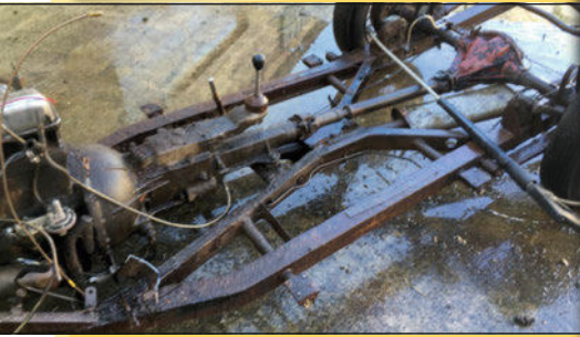
Châssis et organes mécaniques sont couverts de graisse et de boue. Un bon nettoyage haute pression à l'eau chaude va permettre d'y voir beaucoup plus clair.
