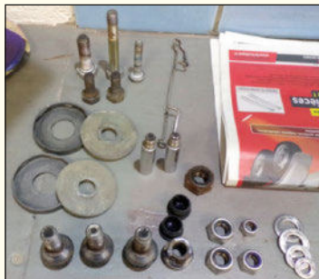
Celles qui nécessitent une restauration seront, selon la pièce, décapées au bain, microbillées et peintes à la peinture à poudre.
