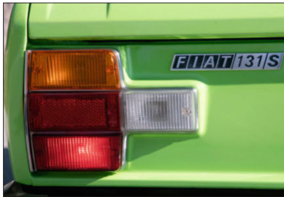
Principale originalité de la Mirafiori : le feu de recul jouxtant l'optique principale. Notez l'embouti de tôle qui en dessine joliment le contour.
