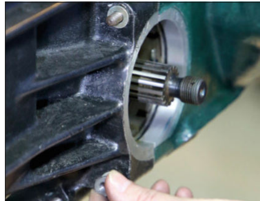
15 Dans un premier temps, on se cantonne aux écrous positionnés autour de la sortie de pont.
