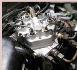
Il ne reste plus qu'à mettre le contact plusieurs fois pour amorcer l'essence jusqu'au doseur et vérifier l'absence de fuite.
