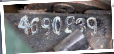
Frappe à froid : visible sur la carrosserie, derrière l'aile avant droite.
