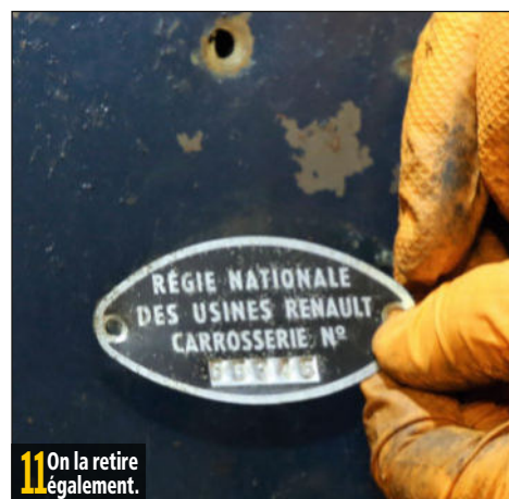
8 La plaque de type est dotée de rivets spécifiques qu'on essaiera de remettre.
