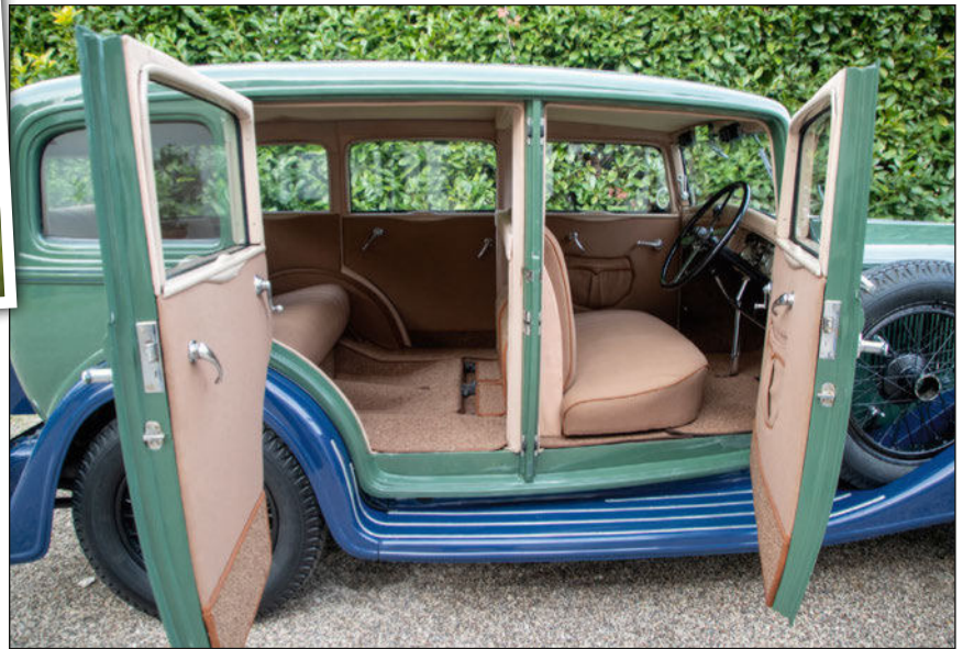
La largeur étonnante du marchepied est l'élément le plus gênant lorsque l'on monte à bord. L'angle d'ouverture de la porte avant est en partie limité par la présence, sur l'aile, de la roue de secours.
