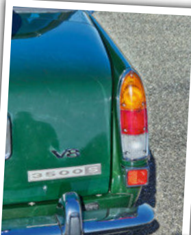
"V8 3500 S" : le top de la P6 ! Les feux arrière inclinés à la pointe des ailes font étrangement penser à ceux des MGB. Les catadioptrés ont été ajoutés en 1971 pour répondre à de nouvelles normes.
