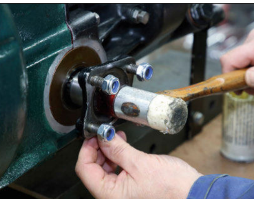
7 On s'aide d'un mallet pour le pousser sur l'arbre.
