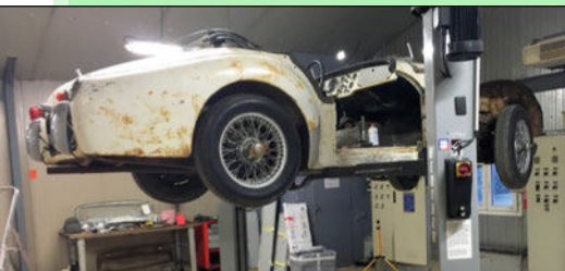
« Je me suis équipé d'un pont à deux colonnes, indispensable quand on entame une restauration complète », se satisfait Ghislain. Ainsi, le démontage de l'auto et la préparation de la dissociation du châssis et de la carrosserie sont confortables.
