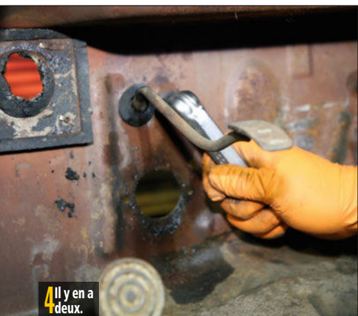
1 Sur la traverse inférieure, il reste la commande d'accélérateur.
