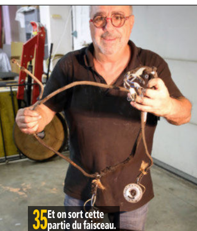
32 On extrait le faisceau du creux de l'aile.
