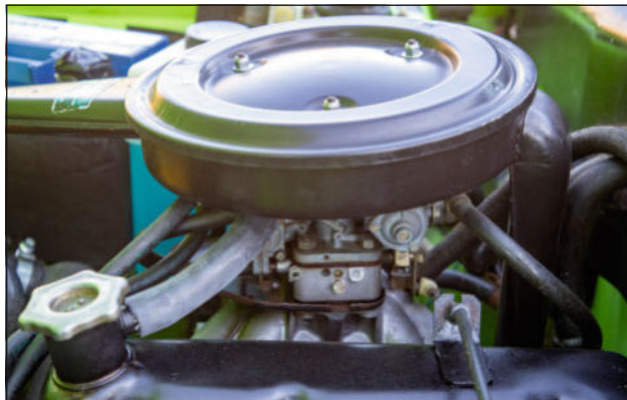
Le carburateur double corps Weber est presque invisible sous l'énorme couvercle du filtre à air.
