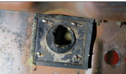
1 Près de la pédale d'accélérateur, on trouve le joint d'étanchéité, très basique, de la colonne de direction.
