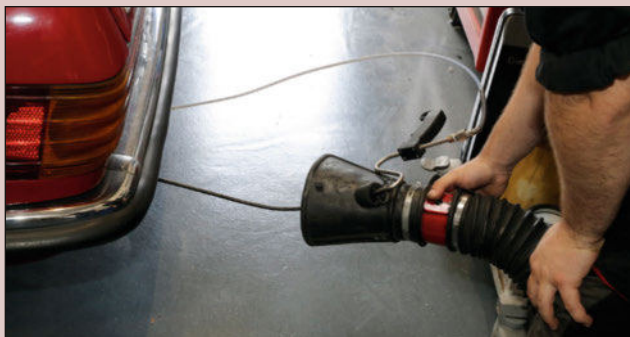
On place la sonde et l'évacuation des fumées sur la sortie d'échappement.
