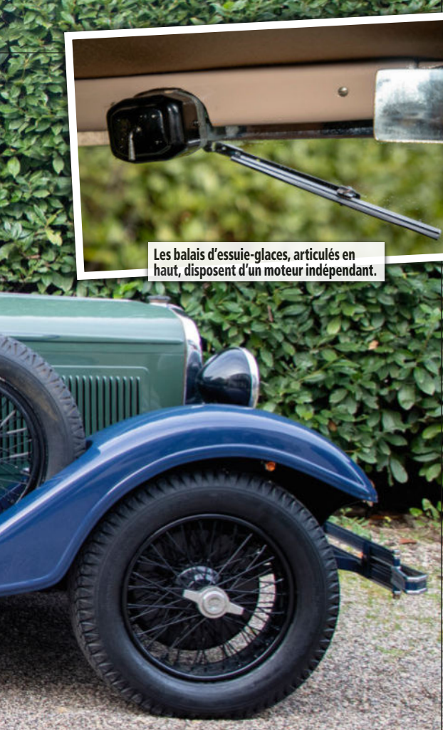
La largeur étonnante du marchepied est l'élément le plus gênant lorsque l'on monte à bord. L'angle d'ouverture de la porte avant est en partie limité par la présence, sur l'aile, de la roue de secours.
