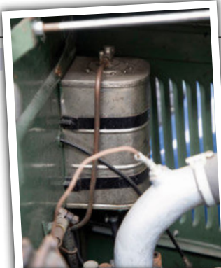
Les toutes premières 469 s'alimentaient par gravité. A partir de 1928, elles sont passées à la pompe à essence, avec ce "poumon" accroché à l'auvent qui gardait une petite quantité de carburant près du carburateur.
