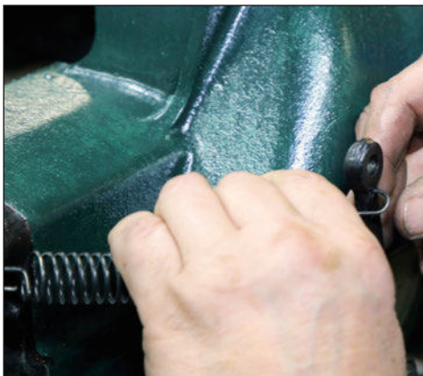
31 Puis on l'accroche à la tige de commande d'embrayage.
