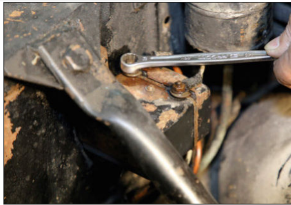
15 A l'aide d'une clé de 10 mm, on desserre le fil marron (4 mm 2 ) qui arrive du + de la batterie.
