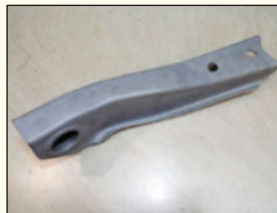
Décapé et microbillé, le bras de suspension sera recouvert d'une peinture en poudre.
