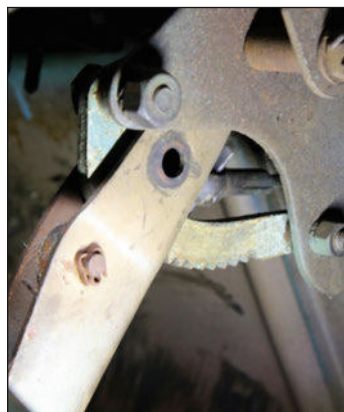
8 On voit que l'embout du câble est sorti de son logement.
