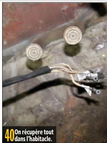
41 Ne reste plus que le faisceau partant vers le maître-cylindre de freins.
