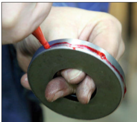
17 On applique un filet de pâte d'étanchéité sur le pourtour des joints d'étanchéité de sortie de pont neufs.
