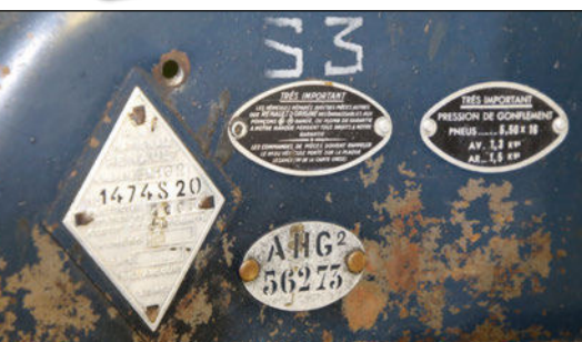
1 Sur la Juva, les plaques d'identification sont nombreuses. On va les enlever délicatement afin de pouvoir les remettre.
