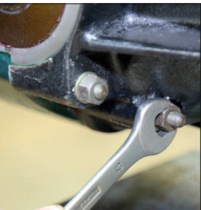
28 On serre ensuite les écrous du bas au moyen d'une clé de 12 mm.
