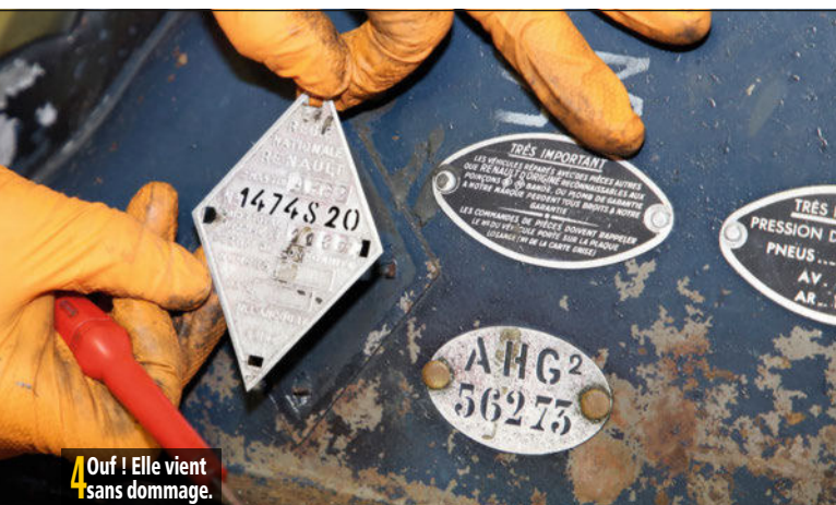
5 Les trois petites plaques ovales (type, pression des pneus, préconisation pièces de rechange) tiennent avec des rivets.
