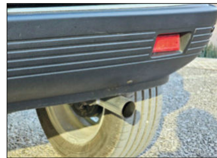
Spécifique à ce modèle, le système d'échappement est très particulier puisqu'il part de l'aile avant gauche pour aboutir derrière la roue postérieure droite.
