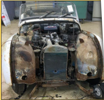
Début du démontage avec la dépose de la face avant. On aperçoit les deux avertisseurs placés de chaque côté du radiateur. Ils sont malheureusement hors d'usage et devront être remplacés.
