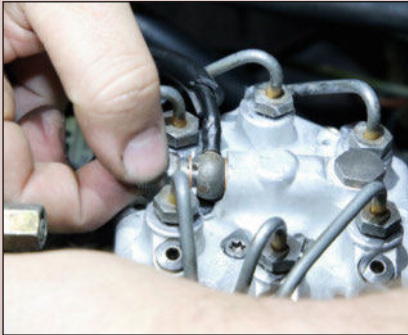
On visse à la main le raccord sur le doseur.
