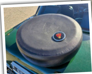
Voici le fameux appendice aérodynamique (très efficace) monté en option sur les 3500. Le médaillon sert à obstruer le trou de fixation de la roue lorsque celle-ci est retirée.
