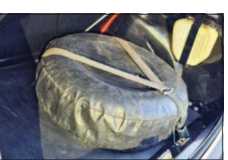
Le volume occupé par le moteur Alpine a imposé un déplacement de la roue de secours qui prend ses aises dans le coffre à bagages. Aucun constructeur n'oserait faire ça aujourd'hui.
