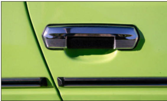
Que ce soit sur la normale ou la S, la Mirafiori utilise ces poignées hexagonales encaissées d'origine 124 troisième série. Sur la deuxième mouture, la moulure de protection couvre l'embouti au lieu de le surmonter.
