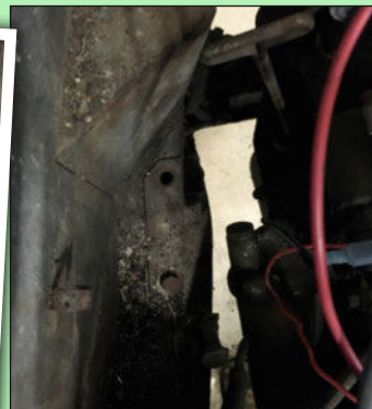
Ghislain commence à enlever les boulons qui lient la carrosserie au châssis. Ici, à l'avant. Il y a huit points de fixation sur une TR3 : deux à l'avant, quatre au niveau du plancher et deux à l'arrière.
