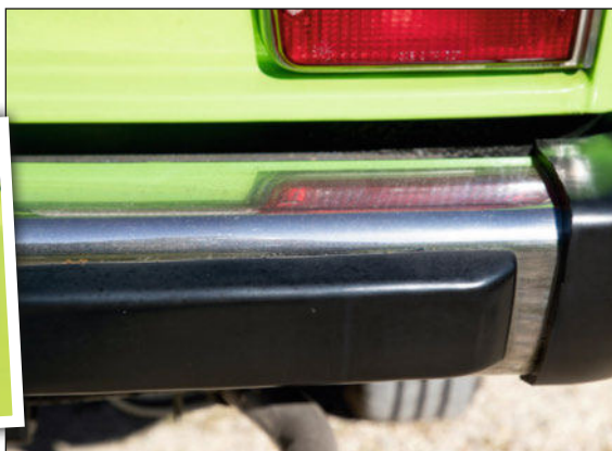
Élément spécifique à la S : la bande caoutchoutée située au milieu du pare-chocs et non seulement sur l'angle, comme sur la 131 Mirafiori normale. En option, Fiat proposait les pare-chocs "américains" à absorption d'énergie pouvant résister, sans se déformer, à des chocs allant jusqu'à 5 km/h.
