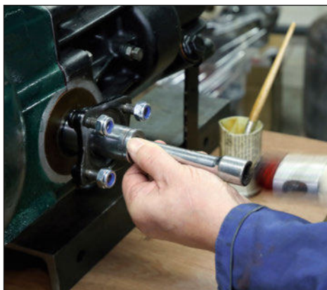
8 Afin de le faire rentrer bien droit, on peut utiliser une douille suffisamment grosse.
