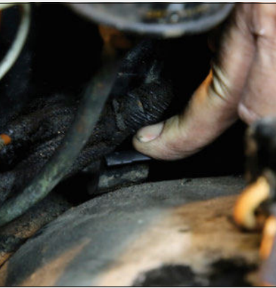
14 On ouvre une patte de maintien du faisceau cachée sur l'arrière de l'aile.
