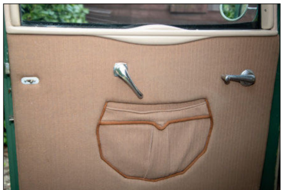
La contre-porte intègre une poignée, en haut, dans l'encadrement de vitre (ouvrable à l'avant comme à l'arrière). Notez, outre la poche auxmunière, la fermeture de sécurité.
