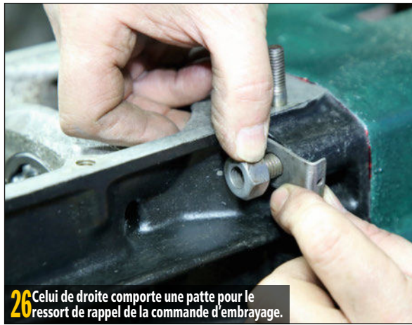
27 On approche cet écrou en maintenant la patte en place.
