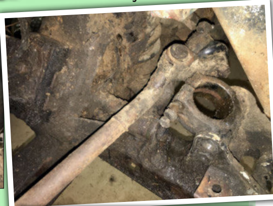
Voici le support de la colonne de direction fraîchement retirée. A gauche, on aperçoit un silentbloc moteur bien vulcanisé.
