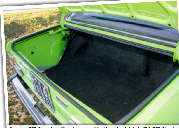
Avec ses 380 litres, le coffre et presque identique à celui de la 124 (375 litres), mais plus petit que celui de la 132 qui peut contenir 432 litres de bagages.
