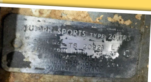
Le numéro de série TS20928L correspond à une TR3, mais pas à une A. Cela signifie que la face avant était à l'origine une "small mouth". La modification se faisait souvent dans les années 60 pour rajeunir les voitures. D'après l'excellent site sur les Triumph de Gérard Guiot ( http://www.tregisterfrance.com ), cet exemplaire daterait d'août 1957.
