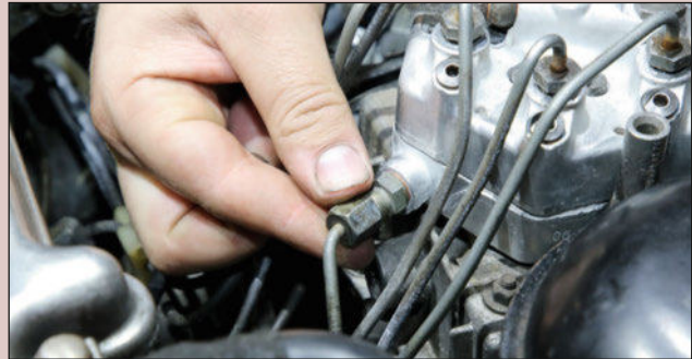
On visse le raccord de la canalisation de l'injecteur de démarrage à froid.
