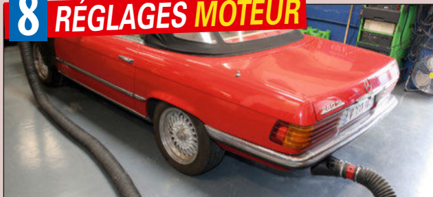
On commence par faire chauffer le moteur et vérifier que le starter se coupe comme indiqué par le constructeur.
