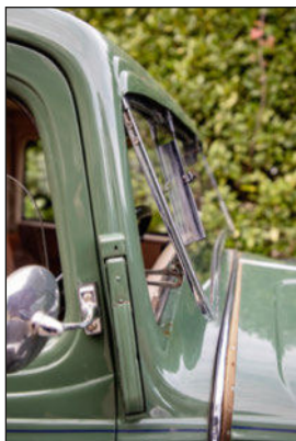
Comme sur beaucoup de conduites intérieures, le pare-brise peut s'entrebâiller pour améliorer la ventilation durant l'été.
