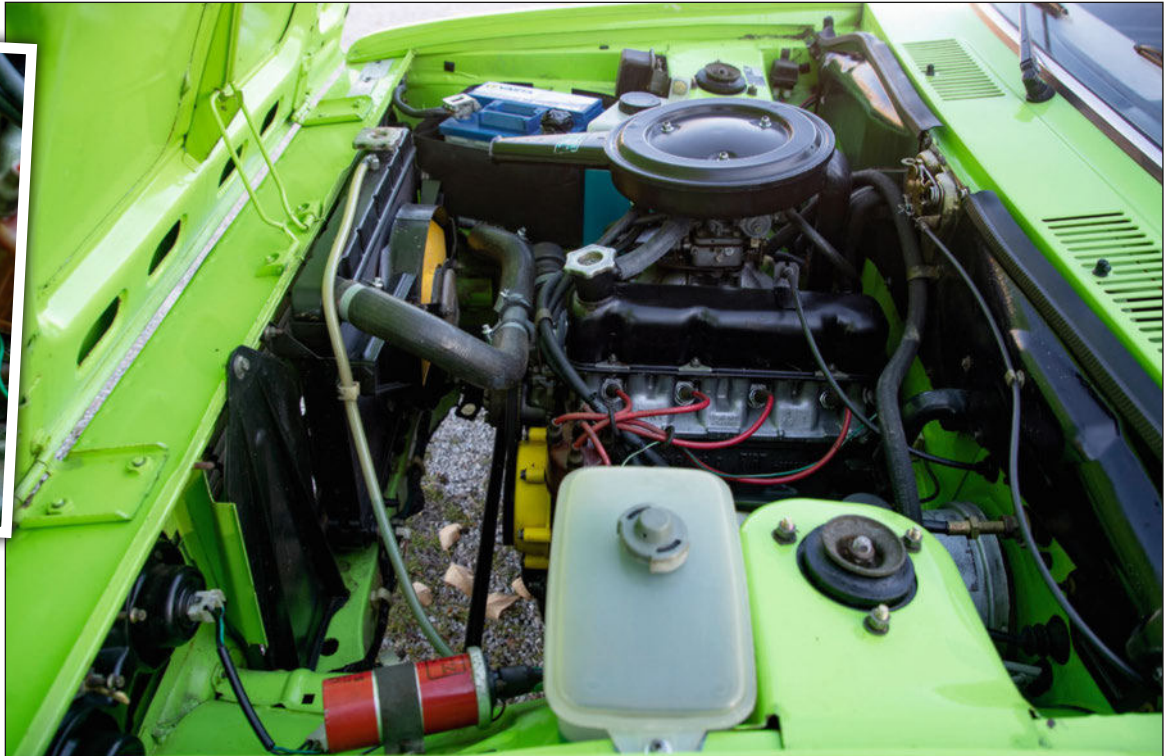
L'espace dans le compartiment moteur est tellement abondant qu'avec un radiateur différent, un 6 cylindres en ligne pourrait aisément y prendre place.
