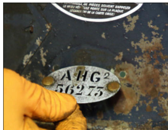
8 La plaque de type est dotée de rivets spécifiques qu'on essaiera de remettre.
