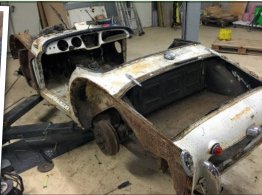
Dépose des compteurs et du tableau de bord central. Les ouvrants et les ailes sont également démontés.
