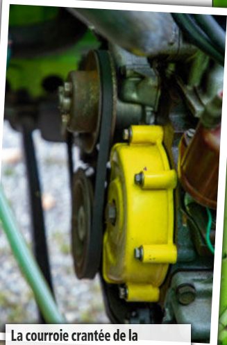
La courroie crantée de la distribution, montée à l'extérieur du moteur, est protégée, comme sur toutes les Fiat de cette époque, par un couvercle en plastique jaune parfaitement identifiable.
