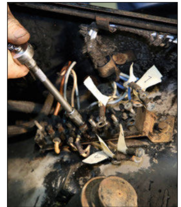
28 On dévisse les fils un à un et on les repère par un numéro.
