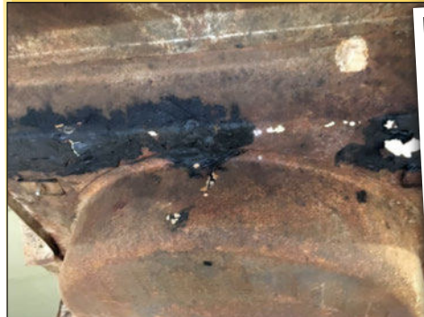
Si le caisson de support de la roue de secours semble relativement en bon état, la tôle du fond de coffre est bien perforée. « Les trous ont été bouchés à l'américaine ! », s'amuse une nouvelle fois Ghislain.
