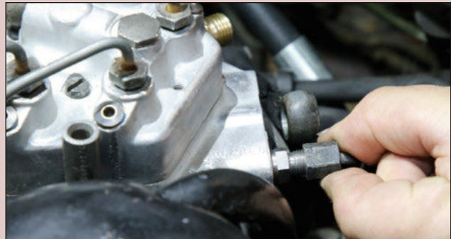
Au tour, ensuite, du raccord d'entrée sur le WUR.
