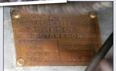
Plaque moteur : placée sur le bloc, côté droit, vers l'avent.
