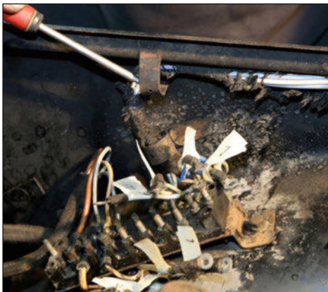
29 Une fois les fils libérés du bornier, on ouvre les pattes de maintien qui courent le long de l'aile.
