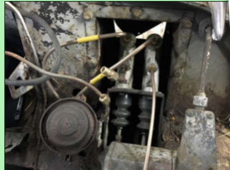
Les émetteurs de freins et d'embrayage ont visiblement été changés. Mais pour plus de sécurité, Ghislain les remplacera par des neufs. En revanche, il conservera le réservoir de liquide qui sera nettoyé et restauré.
