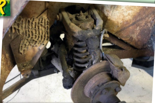
« Après avoir enlevé les roues, je découvre un beau nid de guêpes maçonnées. Il y en a d'autres sur la voiture. Au moins, ça préserve de la rouille, tout comme la graisse qui recouvre les trains roulants », s'amuse Ghislain.
