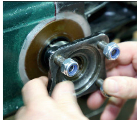
6 On place donc le plateau de sortie sans se soucier de sa position.
