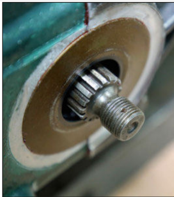
4 Il ne sera pas inutile de légèrement graisser les cannelures et filetages des demi-arbres de sortie.
