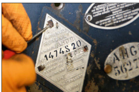
2 On commence par la plaque constructeur dont on soulève avec soin les pattes de maintien.
