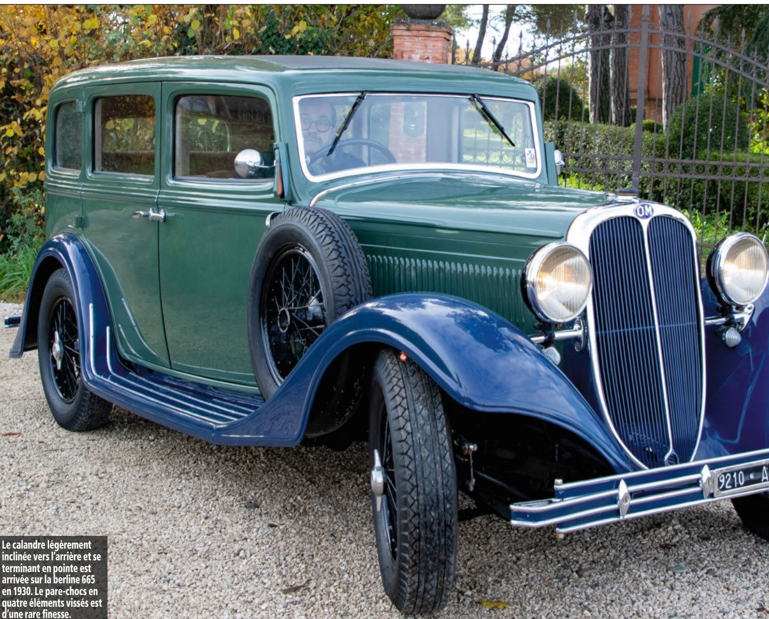
Cachée par la lame du pare-chocs, une traverse de renfort est boulonnée entre les ailes. Le trou de manivelle présent en cas de panne de démarreur électrique était incontournable.
