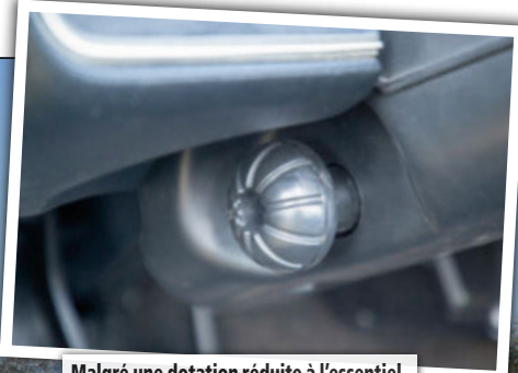
Malgré une dotation réduite à l'essentiel, la S est munie d'une colonne de direction réglable grâce à cette molette.
