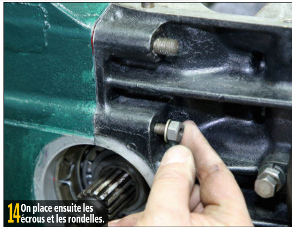
15 Dans un premier temps, on se cantonne aux écrous positionnés autour de la sortie de pont.
